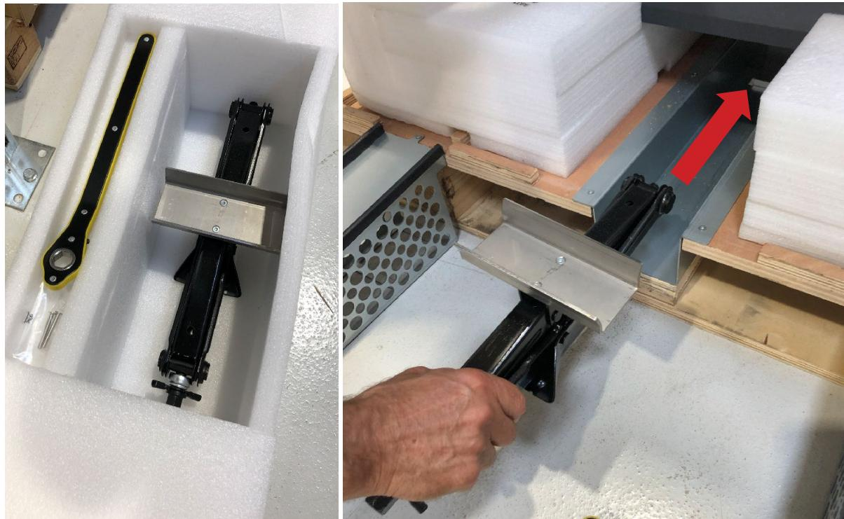
Inizialmente ruotare manualmente la manopola di sollevamento in senso orario poi passare all'utilizzo della maniglia quando il dispositivo di sollevamento raggiunge la parte inferiore dello scanner.
