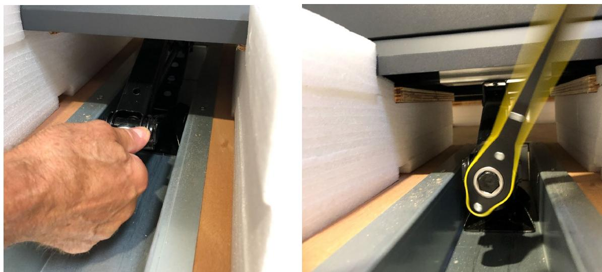
Assicurarsi del corretto posizionamento del dispositivo di sollevamento quando è sufficientemente alto da toccare il fondo dello scanner.
