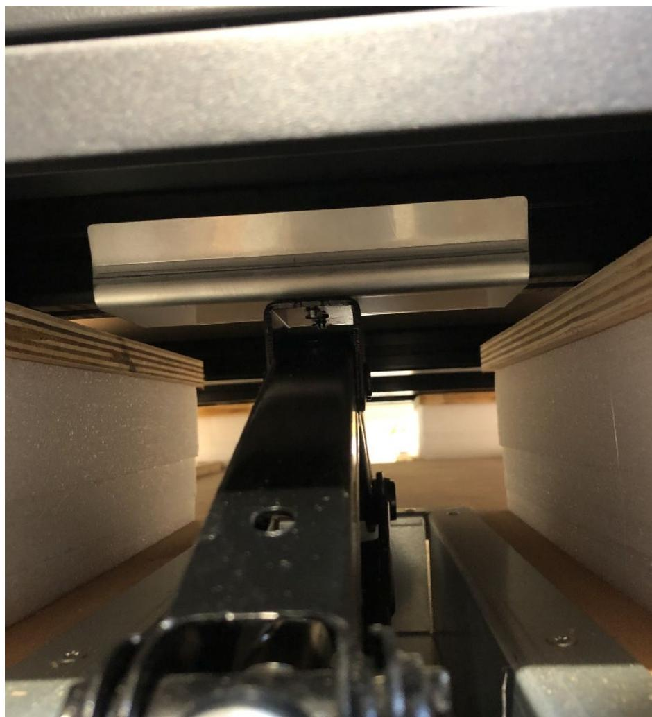
Cessare di azionare il dispositivo di sollevamento quando i blocchi di polistirene e compensato sui bordi dello scanner possono essere rimossi senza esercitare forza. Rimuovere i blocchi di espanso/compensato.
