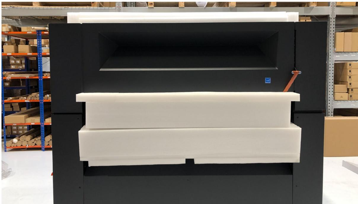
6. Retro: Individuare il cavo di alimentazione, collegare lo scanner all'alimentazione e premere il pulsante per accenderlo. Così facendo si solleva automaticamente il modulo di scansione di 5 cm
